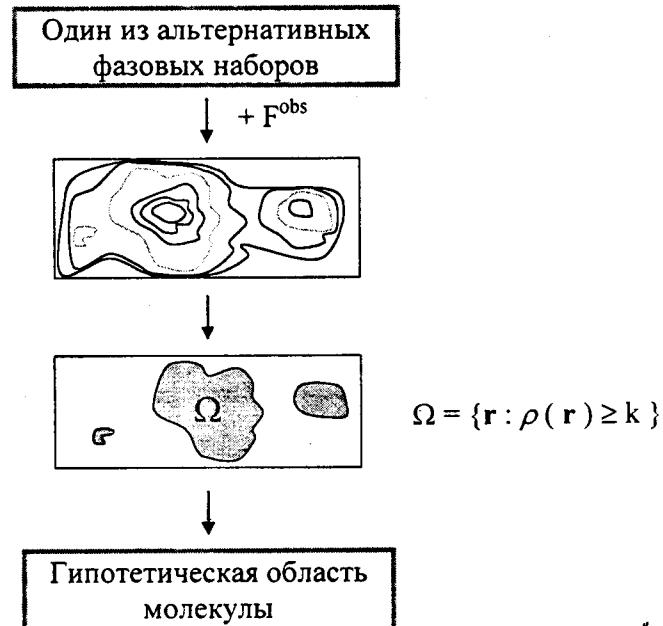
Рис. 2. Схема перехода от задачи выбора наилучшего фазового набора к выбору одной из альтернативных масок области молекулы.
