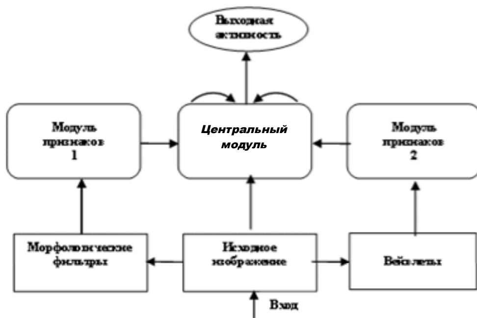
Рис. 2.14. Схема модели сегментации с вниманием, реализованная в виде импульсной нейронной сети [Broussard et al., 1999].
